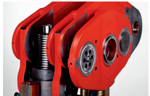
Přestavení beranu během provozu za výrobních podmínek
